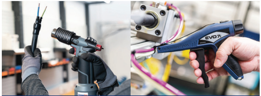
A sinistra: la pistola a caldo alimentata a gas CHG900. A destra: l'attrezzo manuale per fascette EVO7i.
