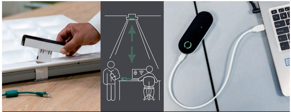
A sinistra: una luce con ricetrasmittitore. Al centro: il principio. A destra: la Chiave di accesso USB.
